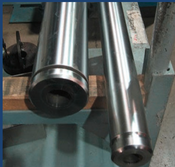
Prüfkörper Hohlzylinder (D150/L500)
